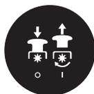
Levante o botão de ativação da lâmina para engrenar. Pressione o botão de ativação da lâmina para baixo para desengrenar.
