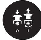
Podignite prema gore gumb za aktiviranje noževa. Gumb za aktiviranje noževa pritisnite prema dolje kako biste ih deaktivirali.
