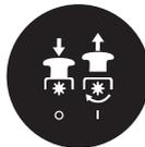
Za aktiviranje rezila privzdignite gumb za aktiviranje rezila. Za deaktiviranje rezila pritisnite gumb za aktiviranje rezila.
