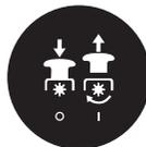
Suba el botón de accionamiento de las cuchillas para acoplarlas. Presione hacia abajo el botón de accionamiento de las cuchillas para desacoplarlas.
