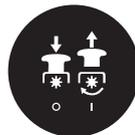
Zvednutím knoflíku zapínání nožů je zapnete. Stisknutím tlačítka zapínání nožů odpojte nože od pohonu.
